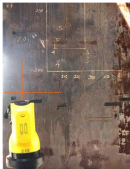
a) Định vị thước chuẩn bằng Laser
